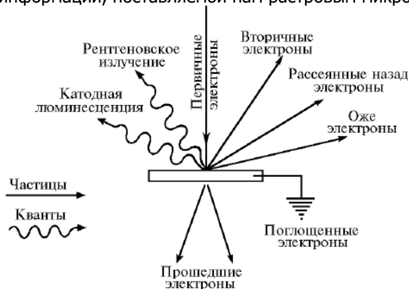
Рис. 2. Схема образования вторичных сигналов при взаимодействии электронов зонда с веществом мишени
