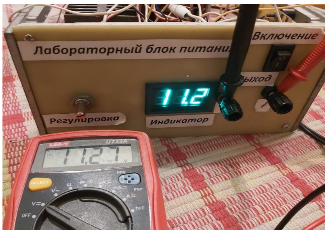
Рисунок 8 - проверка блока питания с помощью мультиметра.
